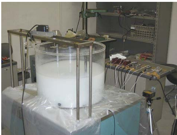
図-6 スロッシング高抑制技術の開発実験
