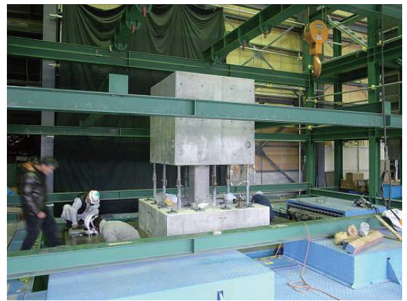
図-4 防災研究所におけるRC、UBRC柱の振動台実験
