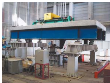
慣性力载荷によるバリアブルダンパーの実時間ハイブリッド試験装置
