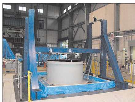
振動台へモデルタンクを載せてのスロッシング実験の状況
