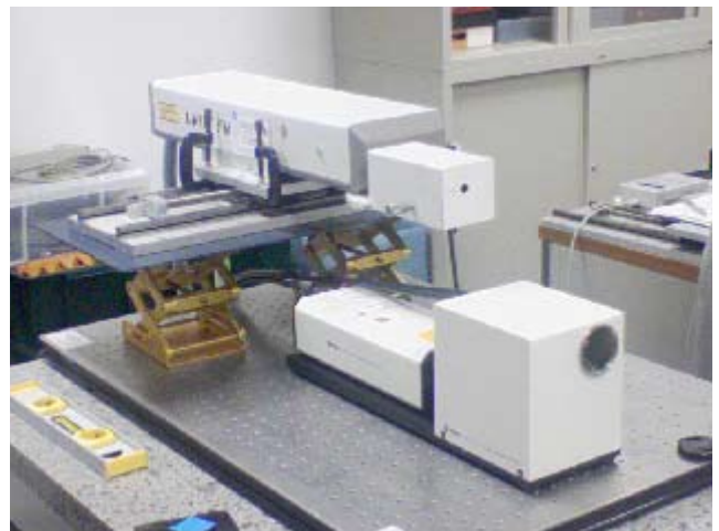
図-5 レーザー超音波実験装置
