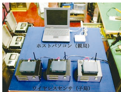
写真-2 可搬型構造同定システム
