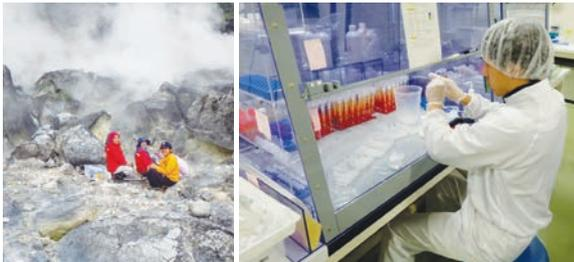
図 4 (左) インドネシア地熱地帯における火山ガスと熱水試料のサンプリング、(右) クリーンルームでの地下水試料分析用の前処理事業
