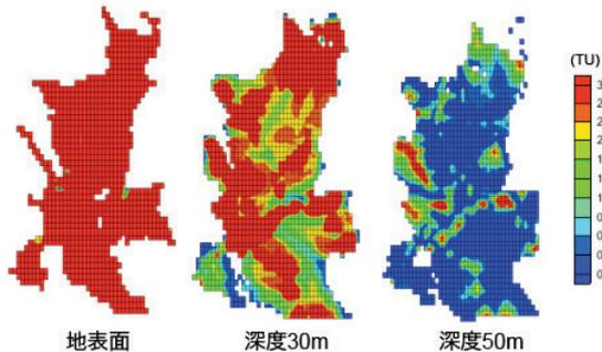
図 5 地下水流動解析と物質移行解析による 1953 年時点での地下水トリチウム濃度の推定分布：京都盆地の例
