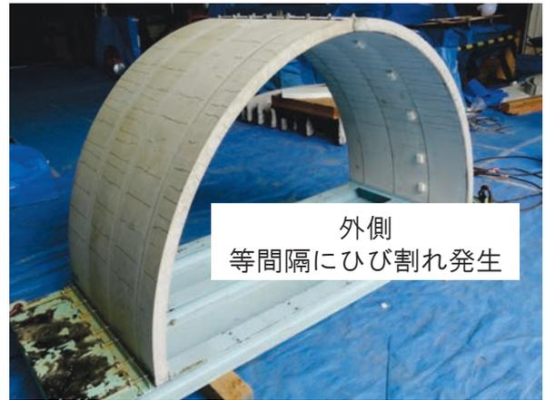
写真1 強震応答振動台実験後のプレキャストアーチカルバート
