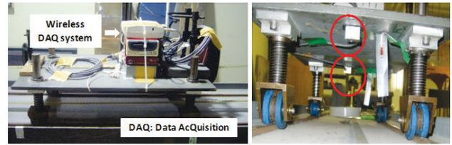
図6 移動橋梁点検のための模型橋梁車両走行実験
