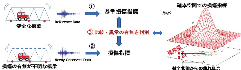
図1 橋の振動データによる損傷検知の概念
