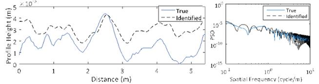
図7 模型実験の車両振動による路面凹凸同定例
