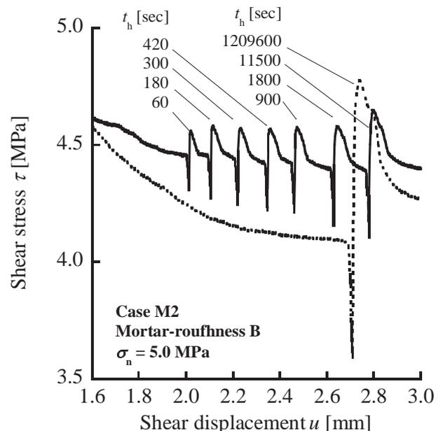
図5 Slide-Hold-Slide型一面せん断試験で得られた岩石不連続面の摩擦抵抗挙動
