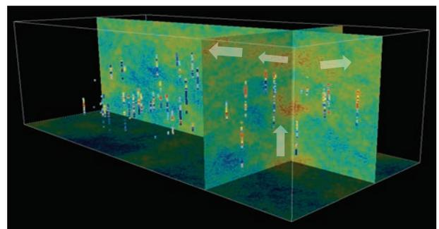
図3 ボーリングデータを用いた地球統計学的シミュレーションによる黒鉱鉱床での銅濃度分布(寒色が低濃度で暖色が高濃度)と鉱液の推定パス(矢印)
