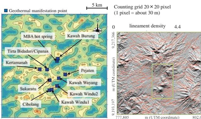
図1 亀裂情報の高精度抽出例：Wayang Windu地熱地区(インドネシア)でのリニアメント密度マップと地熱兆候点の分布
